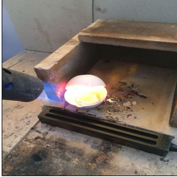
Resim 4. Has gümüşün eritilip çubuk dereceye dökülmesi
