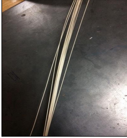
Resim 9. Gümüş tellerin eşit boylarda kesilmesi
